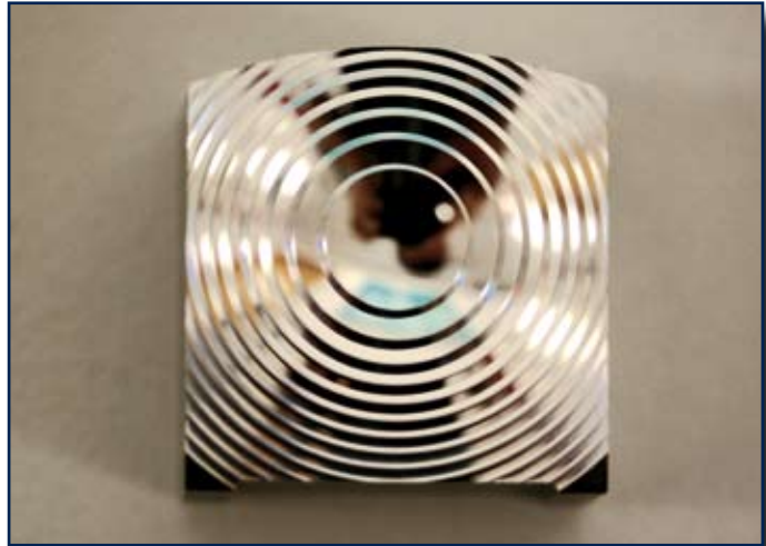
Werkzeugeinsatz für eine Fresnel-Linse im Messgerätebau
